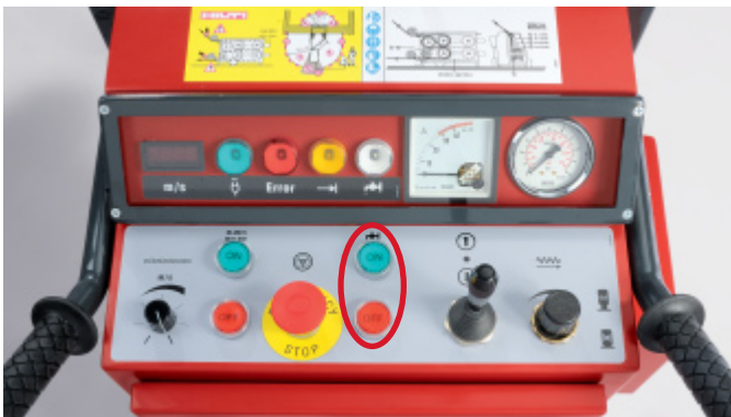
Steuerpult Wasser Ein / Aus
